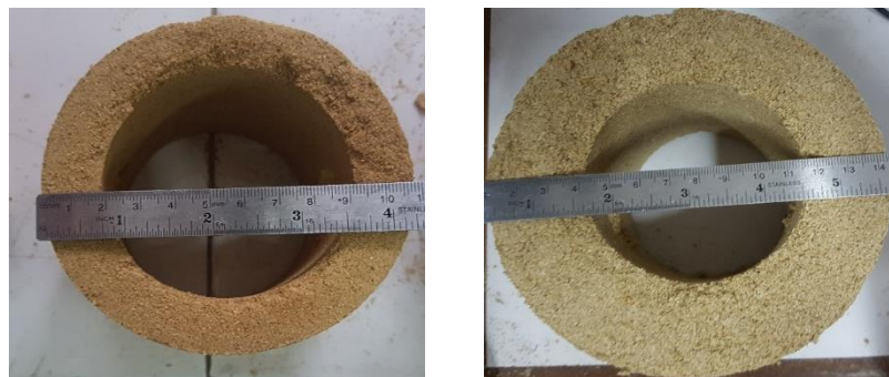
Gambar 1. Variasi ketebalan sleeve 15 mm (kiri) dan 25 mm (kanan)
